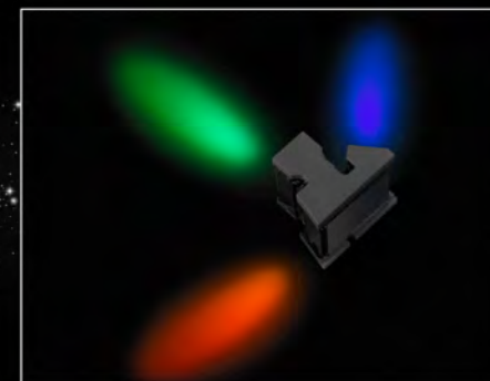
Tres sensores CMOS de 2/3" con obturador global
